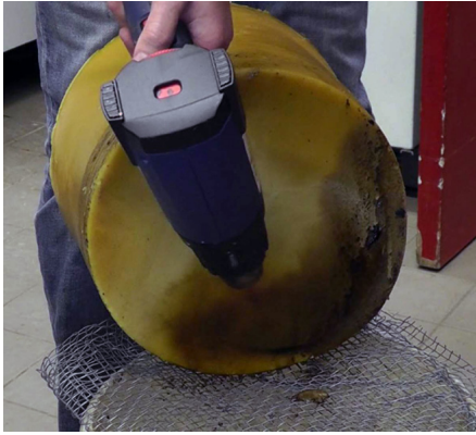
Abb. 10 - Mit einem Heißluftfön lässt sich die Schmutzschicht am Boden des fertigen Wachsklotzes leicht in einen untergestellten Eimer mit Müllbeutel abschmelzen.
