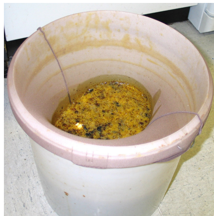
Abb. 07 - Den kochenden Wachs-Wasser-Dreck-Sud vorsichtig in einen leeren Strumpfhosensieb-Eimer gießen. Der Eimer kann ganz voll sein. Er platzt nicht.
